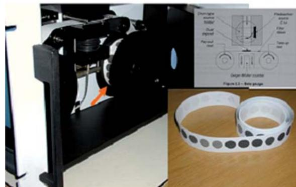
Bild 5: Ein PM<sub>10</sub> Messgerät. Die Luft wird durch einen Bandfilter gesaugt. Die Staubteilchen werden dort zurückgehalten und je nach Staubbelastung bildet sich ein mehr oder weniger dunkler Fleck
